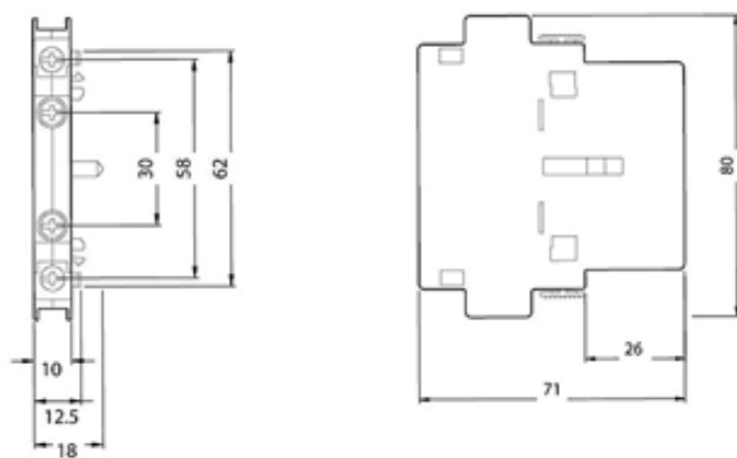
Рис. 3 Габаритные размеры 3RH1921-1EA
